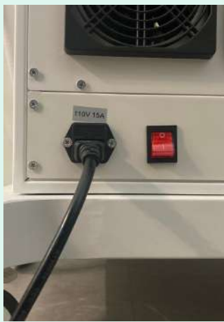
① マシン後側のコンセントがさしてあることを確認し、マシン後側にある主電源を入れる
